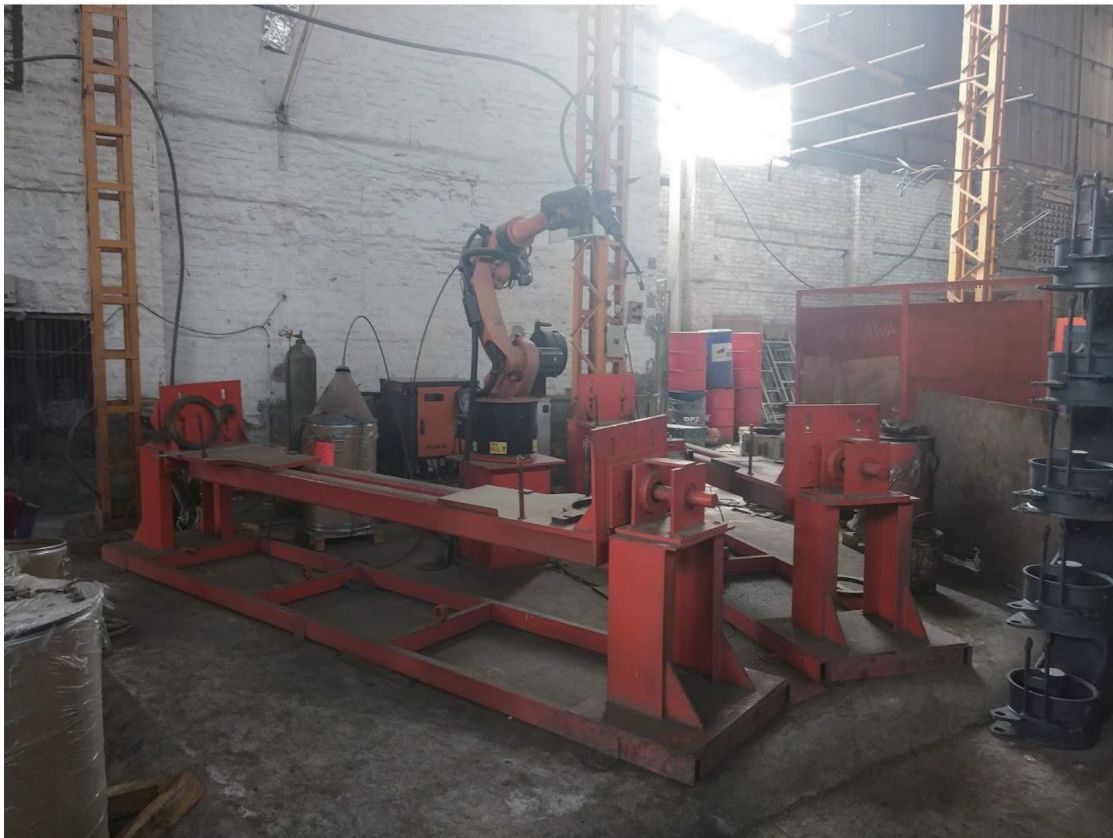
位於 Batala 的 Steel Cut Engineers 公司購置 KUKA 機械手臂以取代焊接工人。
