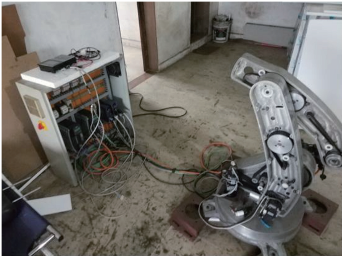
Minimatic Machines 公司第二代兄弟檔經營團隊嘗試自行開發簡易機器手臂，以解決技術人才缺乏以及人工無法維持產品品質穩定的問題。
